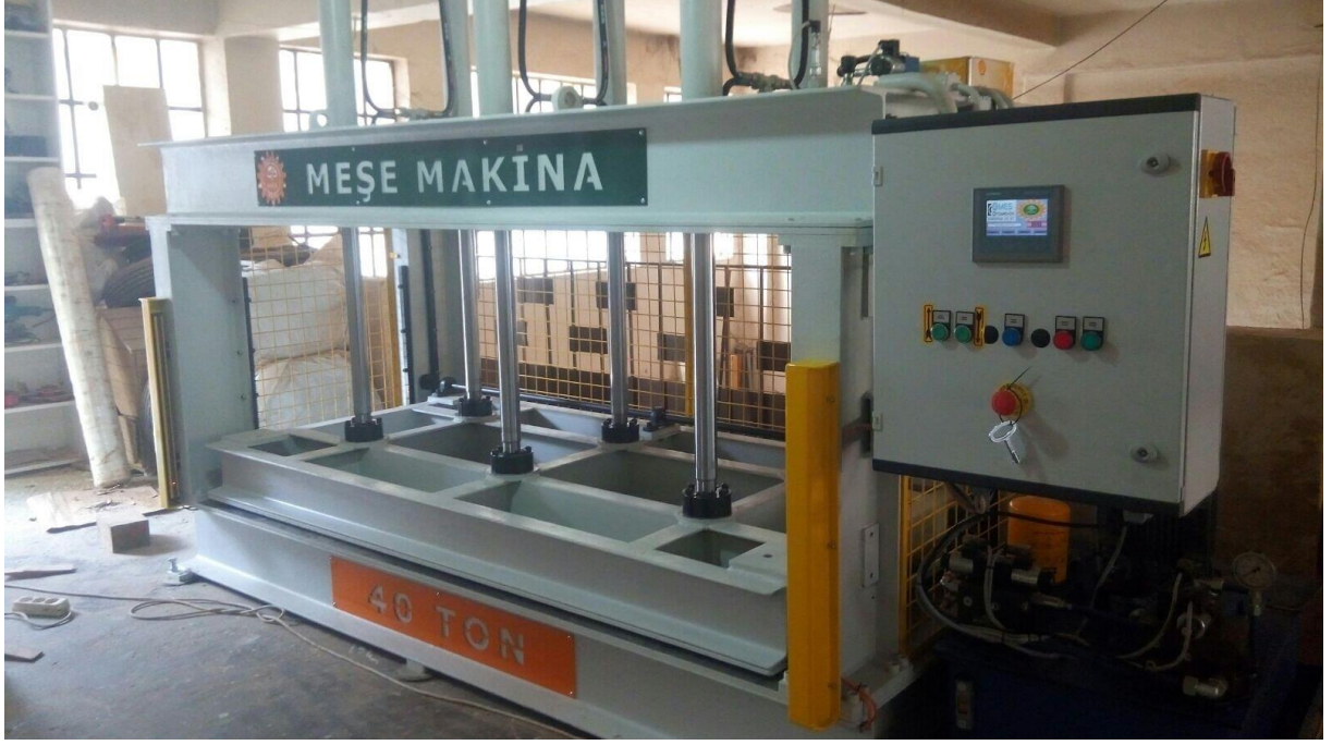
Hidrolik presin uygulaması
